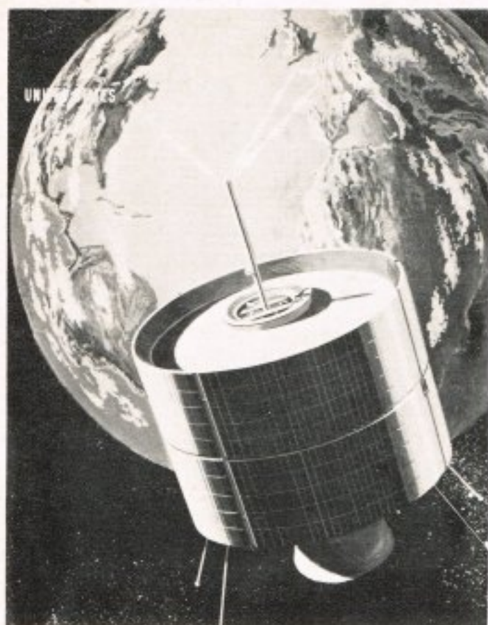
Fig. 10.20. Sådan går det til, når fjernsynsudsendinger fra USA når os. Der er kun ét »mikrobølgetårn« undervejs – satellitten.
