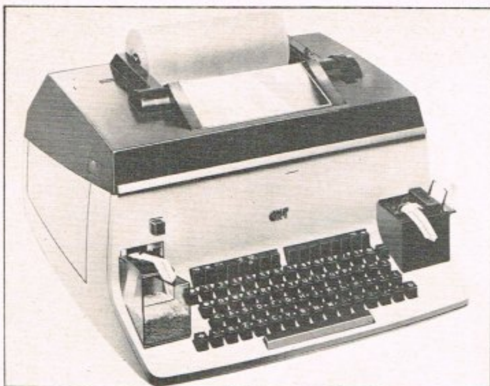
Fig. 10.3. Denne meget moderne fjernskriver kaldes en teleprinter . Man kan enten sende meddelelser ved at skrive på tastaturet, eller man kan sende langt hurtigere ved at indsætte en hulstrimmel i maskinen (til højre). Alt hvad maskinen afsender og modtager bliver registreret på en hulstrimmel, der kommer ud af maskinen til venstre.
