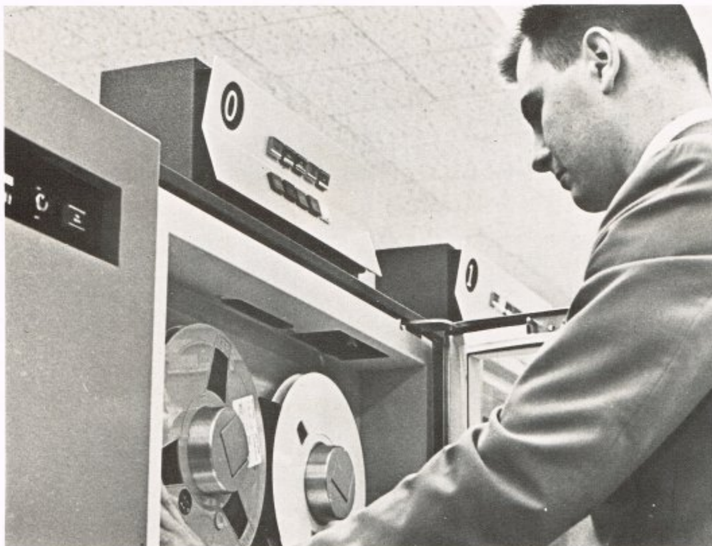
Fig. 9.7. Magnetbåndstation, der dels kan bruges som lager, dels som ind- eller udlæse-enhed.
